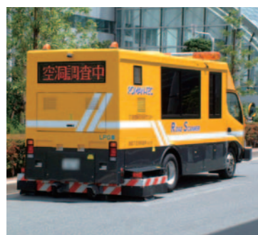
レーダー探査による路面下の空洞調査
