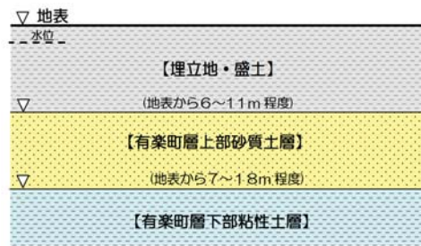
臨海部の埋立地盤の地層構成の例
