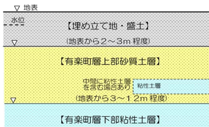
図3-6 内陸部の建物被害が発生した地点における地盤の概念図
