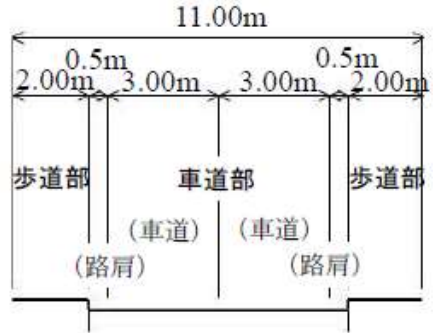
(図C) 幅員 11 mの横断面構成
