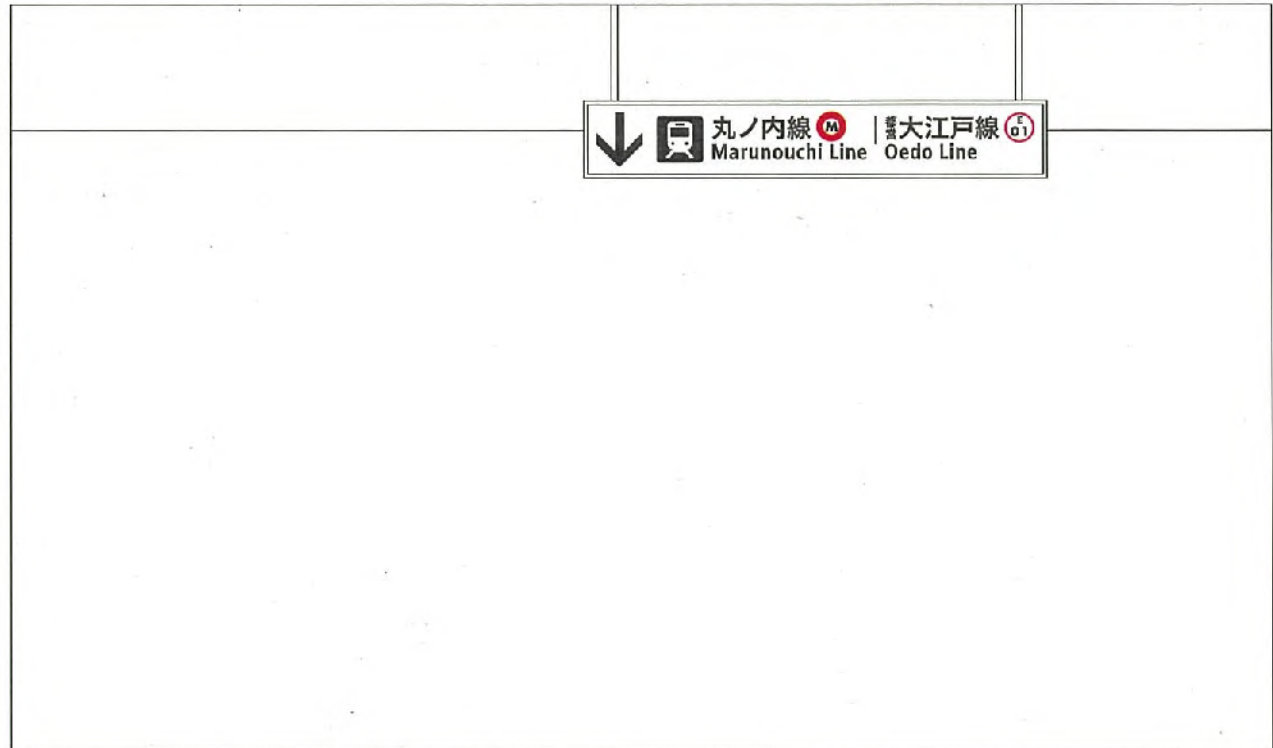
東-6003<両面>オモテ 器具寸法H300×W1800 表示面寸法H270×W1770 (和文文字高90)
