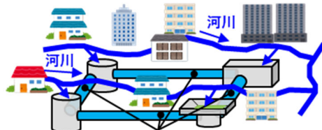
地下トンネルで複数の調節池を広域的に連結 複数調節池の連結によるネットワーク化
