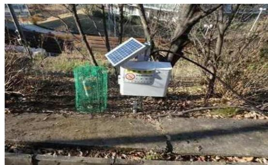
写真7 地盤傾斜センサー
