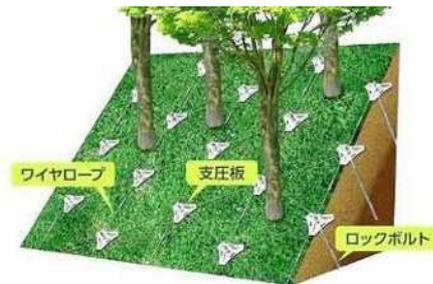
図7 施工イメージ図
