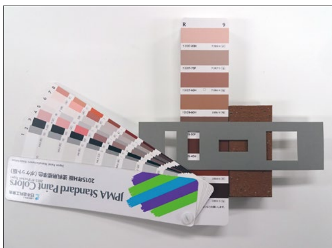
日本塗料工業会標準色見本帳を用いたタイルの測色（視感測色）
