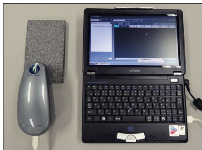
色彩計を用いた自然石の測色（機器測色）
