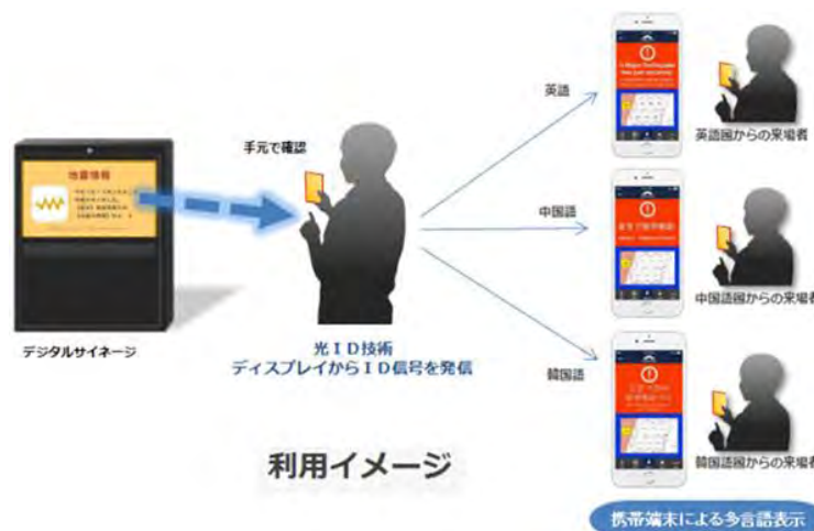
＜光ID技術を活用した多言語対応デジタルサイネージ設置＞
