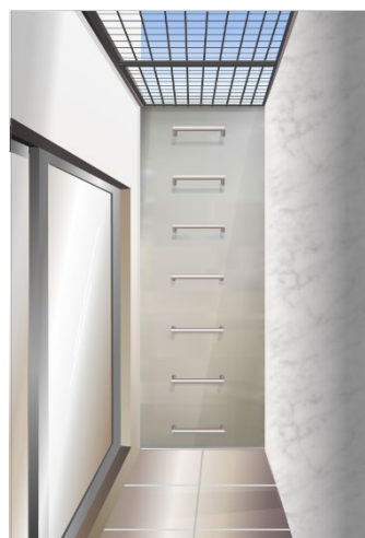
図 43 ドライエリアの脱出用タラップ
