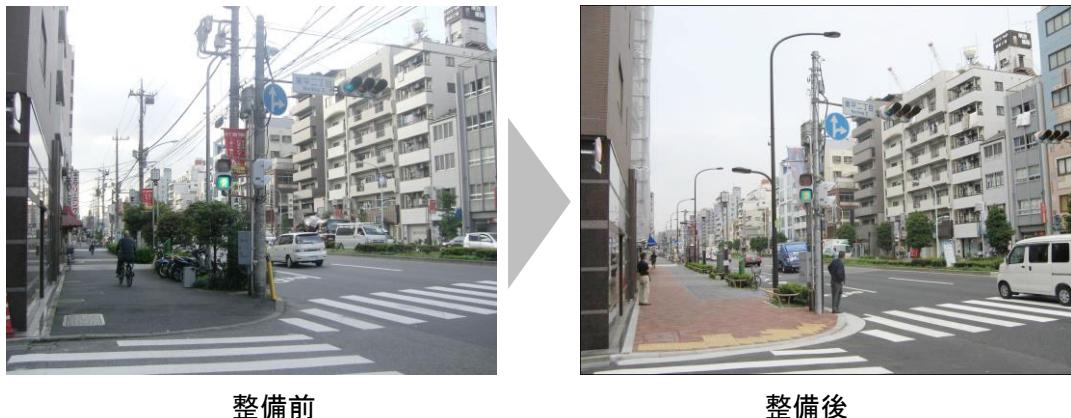
図 4-15 無電柱化と合わせた自転車通行空間の整備事例(墨田区業平、浅草通り)
