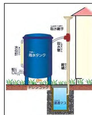
図 4-17 個人住宅への雨水タンクの設置例
