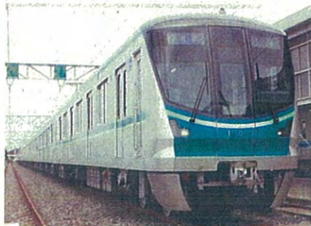
千代田線16000系(36編成360両) (新型モーター等の導入により、従来より20%電力使用量削減を実現)
