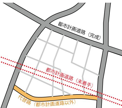
図3-49 既存道路による代替のイメージ（代替路）
