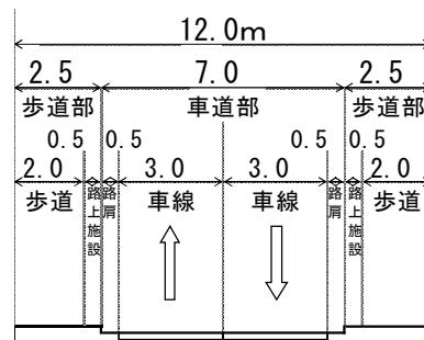
図 3-52 地域的な道路の評価幅員の例
