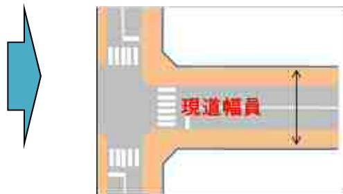
図 3-30 交差する全ての都市計画道路の単路部が完成している交差点拡幅部
