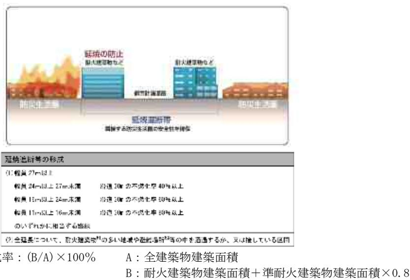
図 3-15 延焼遮断帯の形成
