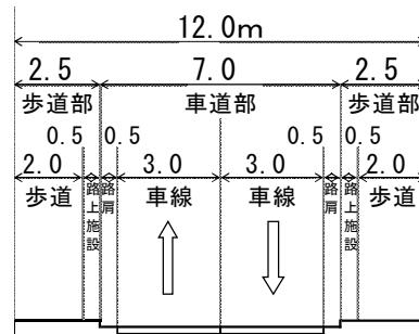
図 3-52 地域的な道路の評価幅員の例
