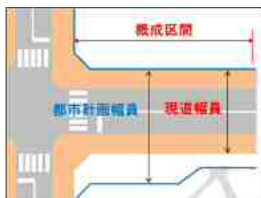
図3-30 交差するいずれかの都市計画道路に現道無道路または概成道路が存在する交差点拡幅部
