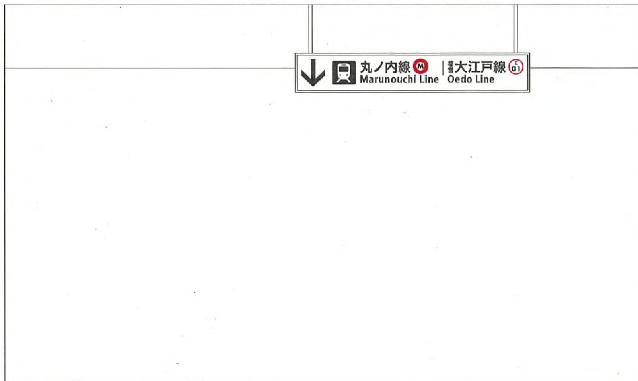
東-6003<両面>オモテ 器具寸法H300×W1800 表示面寸法H270×W1770 (和文文字高90)
