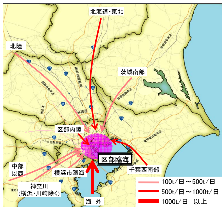
農水産品(常温、定温)の純流動 OD。施設種類は全施設計 資料 東京都市圏交通計画協議会「第4回東京都市圏物資流動調査」 (平成15年度)より作成
