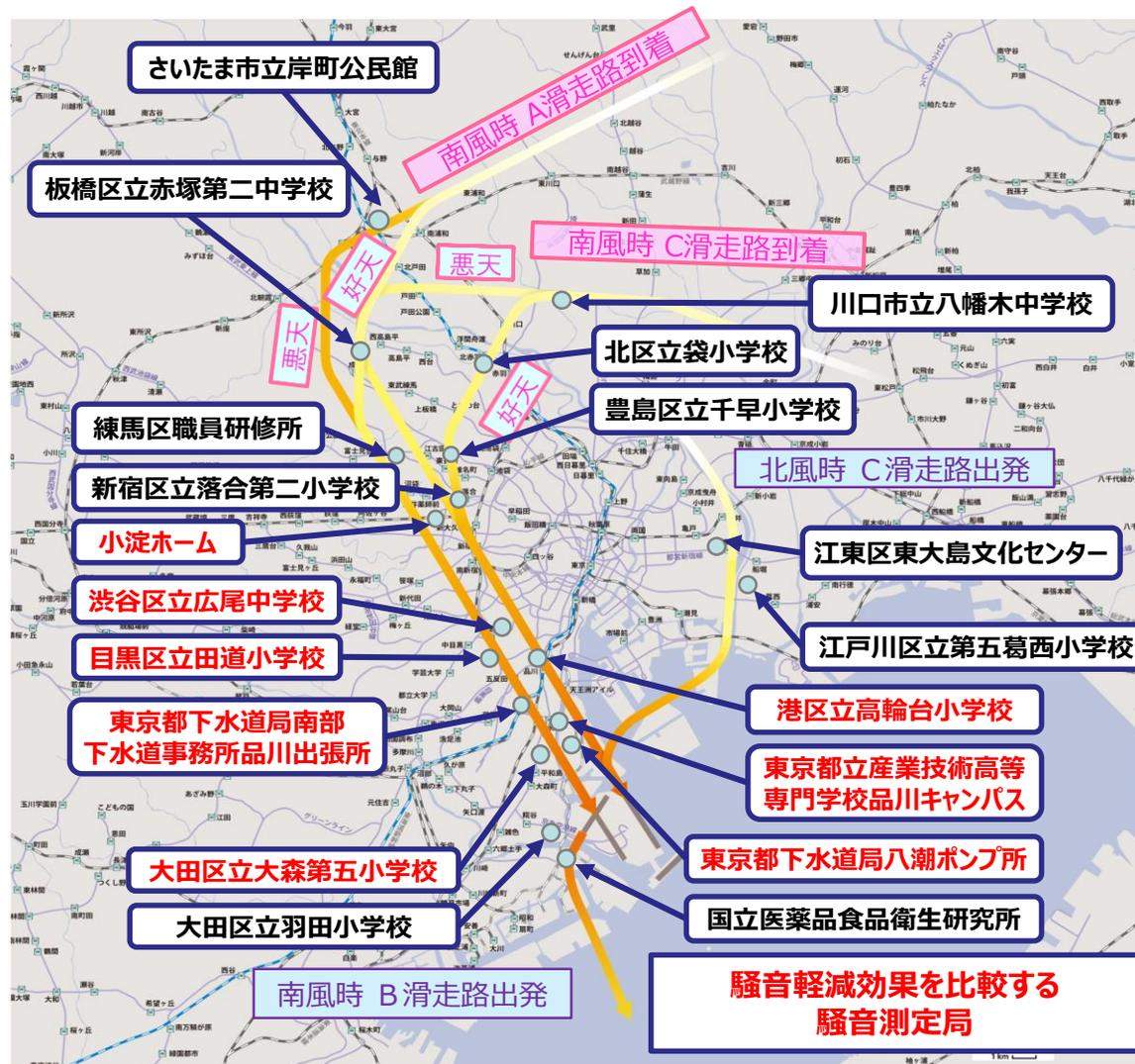
ILS運用時（3度の降下角）の実測値の平均を基準にRNAV運用時（3度より大きい降下角）の実測値の平均を比較したところ、RNAV運用時の方が騒音が小さく、実際に騒音が軽減されていることが確認できた。今後も引き続きモニタリングを実施していく。
