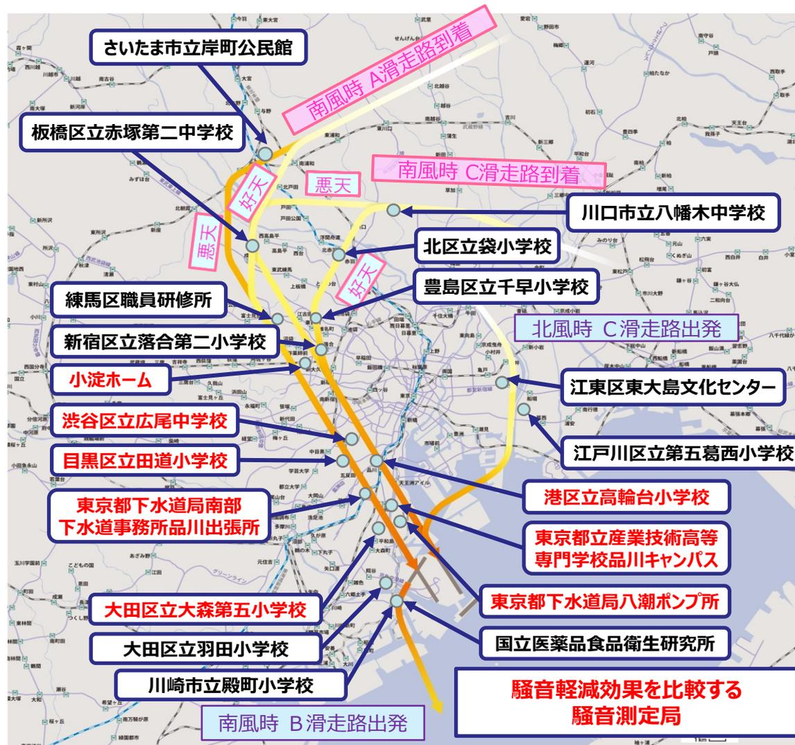
ILS運用時（3度の降下角）の実測値の平均を基準にRNP運用時（3度より大きい降下角）の実測値の平均を比較したところ、RNP運用時の方が騒音が小さく、実際に騒音が軽減されていることが確認できた。今後も引き続きモニタリングを実施していく。
