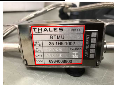
主脚構造部のラベル (大きさ 4cm × 3cm、重量 1g)
