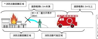
消防車:幅2.5m 震災時に放置され た自動車や倒壊建物 等の影響を考慮して 通行可とされる道路 幅員6.5m以上
