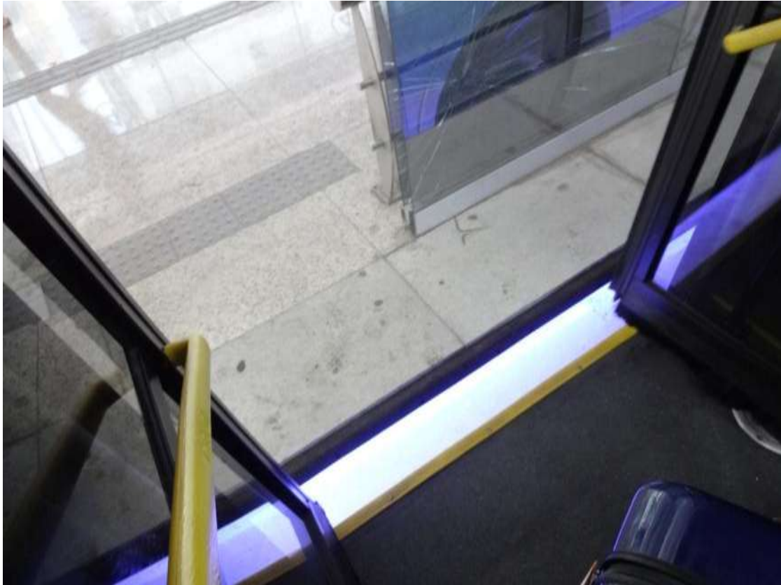
写真：隙間のない停車例（ブラジル・リオBRT）
