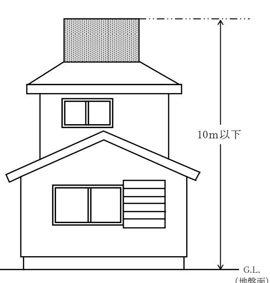
(イ) 鉄筋コンクリート造、鉄骨造等の建築物の屋上に設置する広告物等（地盤面から広告物等の上端までの高さが 10m以下のものは除きます。）の高さは、地盤面から設置する箇所までの高さの 3 分の 2 以下で、かつ、地盤面から広告物等の上端までの高さは、第 1 種住居地域、第 2 種住居地域及び準住居地域内にあっては 33m 以下、その他の用途地域においては 52m 以下としてください。
