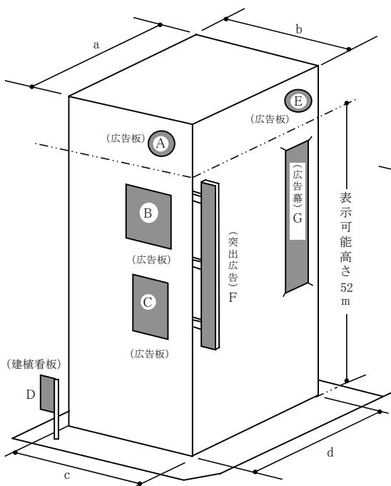
$$\begin{aligned}\text{建築物の高さ } &52\text{m以上} \\ \text{総壁面面積 (W)} &= (a + b + c + d) \times 52\text{m} \\ \text{広告物の総表示面積} &= A + B + C + E + F + G \leq W \times (6/10)\end{aligned}$$
