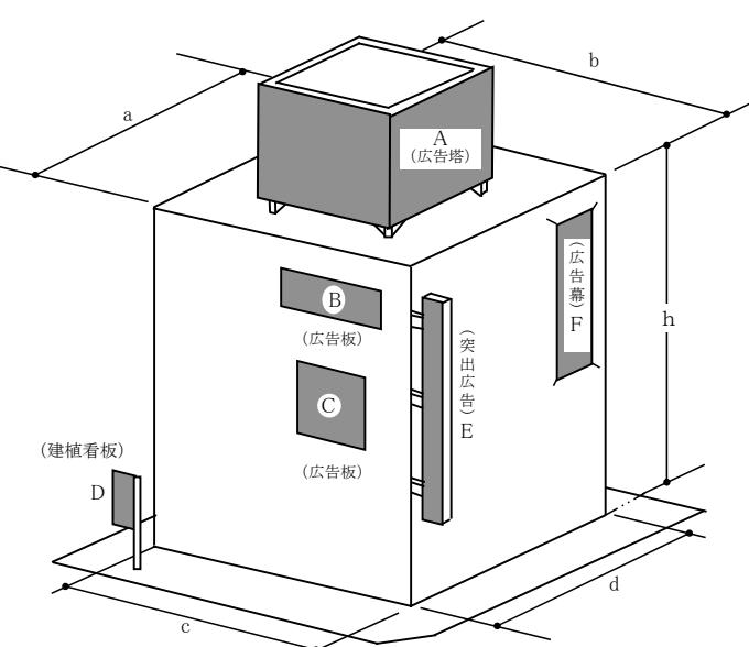
$$\begin{aligned}\text{建築物の高さ } &10\text{m 超~}52\text{m 以下} \\ \text{総壁面面積 (W)} &= (a + b + c + d) \times h \\ \text{広告物の総表示面積} &= A + B + C + E + F \leq W \times (6/10)\end{aligned}$$
