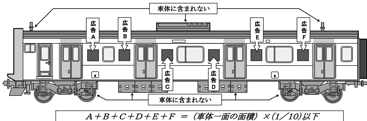
※表示面積の算定にあたっては、電車のボディー(台車、上部の換気口の突起、パンタグラフ等はボディーに含まれない。)を前・後・左・右・上・下に分け、丸みがかった部分は、どちらかと一体と考える。
