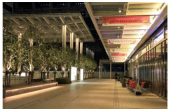
間接光を用いて、グレアを抑制しながら明るさを確保している
