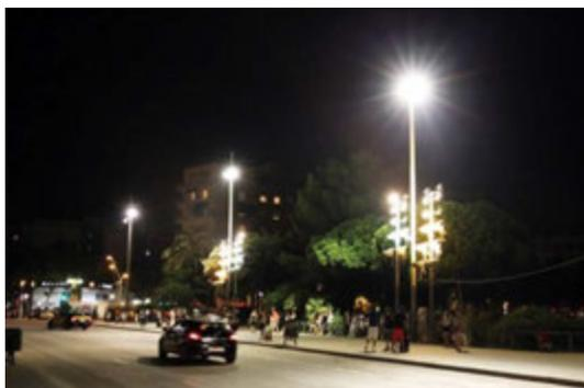
光源が直接目に入ってまぶしいポール照明が設置されている
