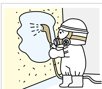
封じ込め工法
