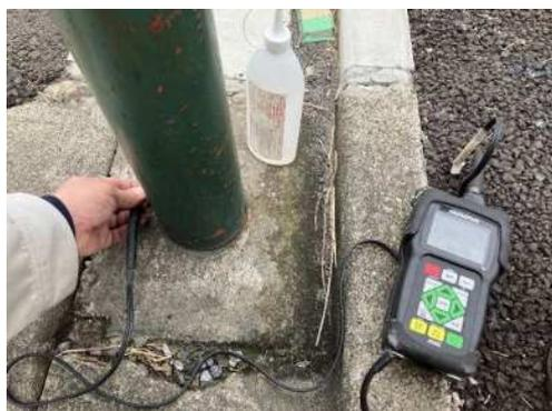
写真6 超音波肉厚測定機 全景
