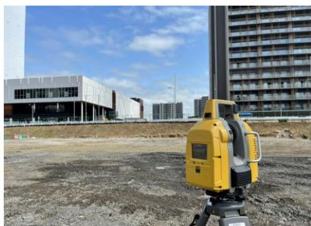
写真1 TLSによる測量状況
