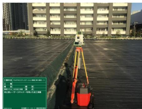
写真2 TLSによる計測状況
