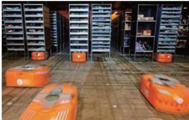
米 Amazon は、物流倉庫において、作業棚を作業員に届ける作業ロボットを導入し、作業の効率化や人件費の削減、配達の迅速化に向けた取組を進めています。
