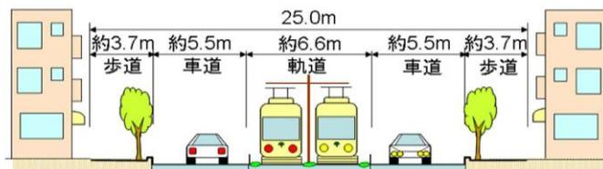
◆ 補助第81号線の整備イメージ断面図
