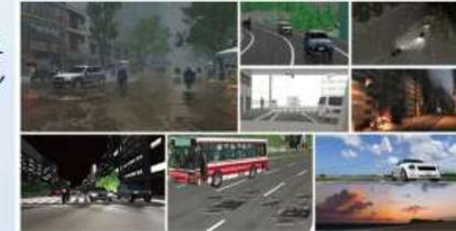
簡単な操作で3D地形を生成、PLATEUやOSMから建物、樹木の3Dモデルを配置し、道路生成、交通流生成など、専門家でなくとも任意の地域の大規模な3次元空間を容易に作成し、環境を含めたシミュレーションが可能。
