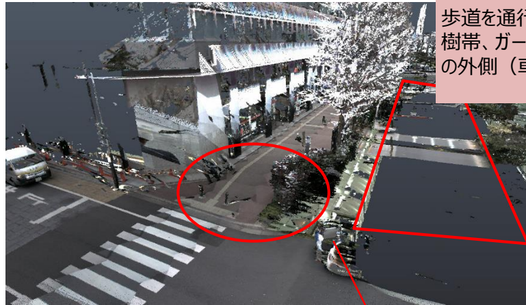
歩道を計測したMMSデータ
