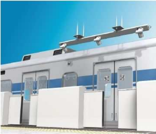
自動開閉制御システム（イメージ）
