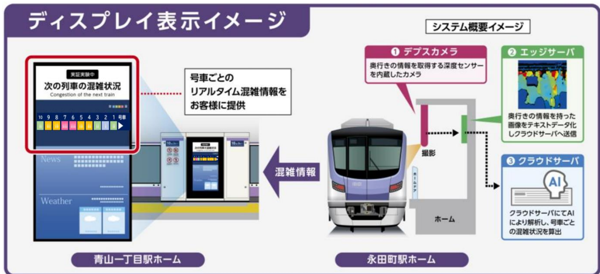
図-22 列車・車両別混雑度の計測および混雑情報提供の実証実験
