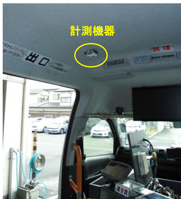
計測機器設置例
