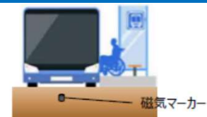
磁気マーカーによるバス停等における正着制御のためのインフラからの支援 出典：国土交通省資料
