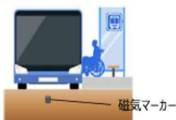
磁気マーカ-によるバス停等における正着制御のためのインフラからの支援
