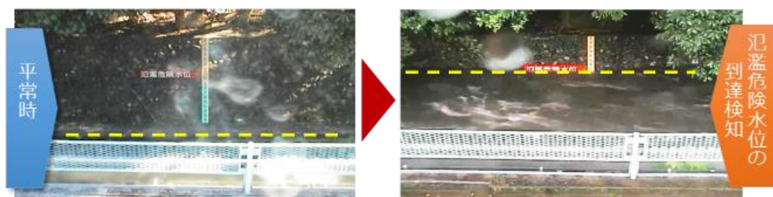
図 4-34 AI 等を用いた河川監視カメラの自動解析のイメージ
