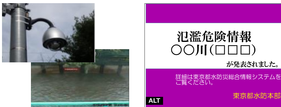
図 4-33 河川監視カメラ等観測機器の設置およびX（旧 Twitter）を用いて 氾濫危険情報（水位周知河川）をポストするイメージ
