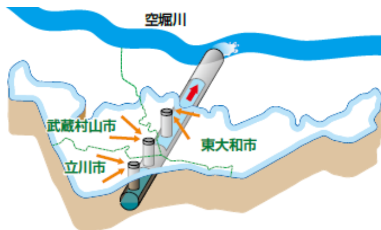
図 4-17 空堀川上流雨水幹線のイメージ
