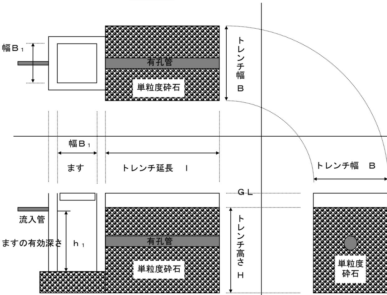
(注) トレンチの有効水深  $h_2$  は、トレンチをある断面で切ったときの空隙の面積をトレンチ幅で除した値で、トレンチが貯留できる水深を表したものである。従って、図面上ではあえて表示していない。
