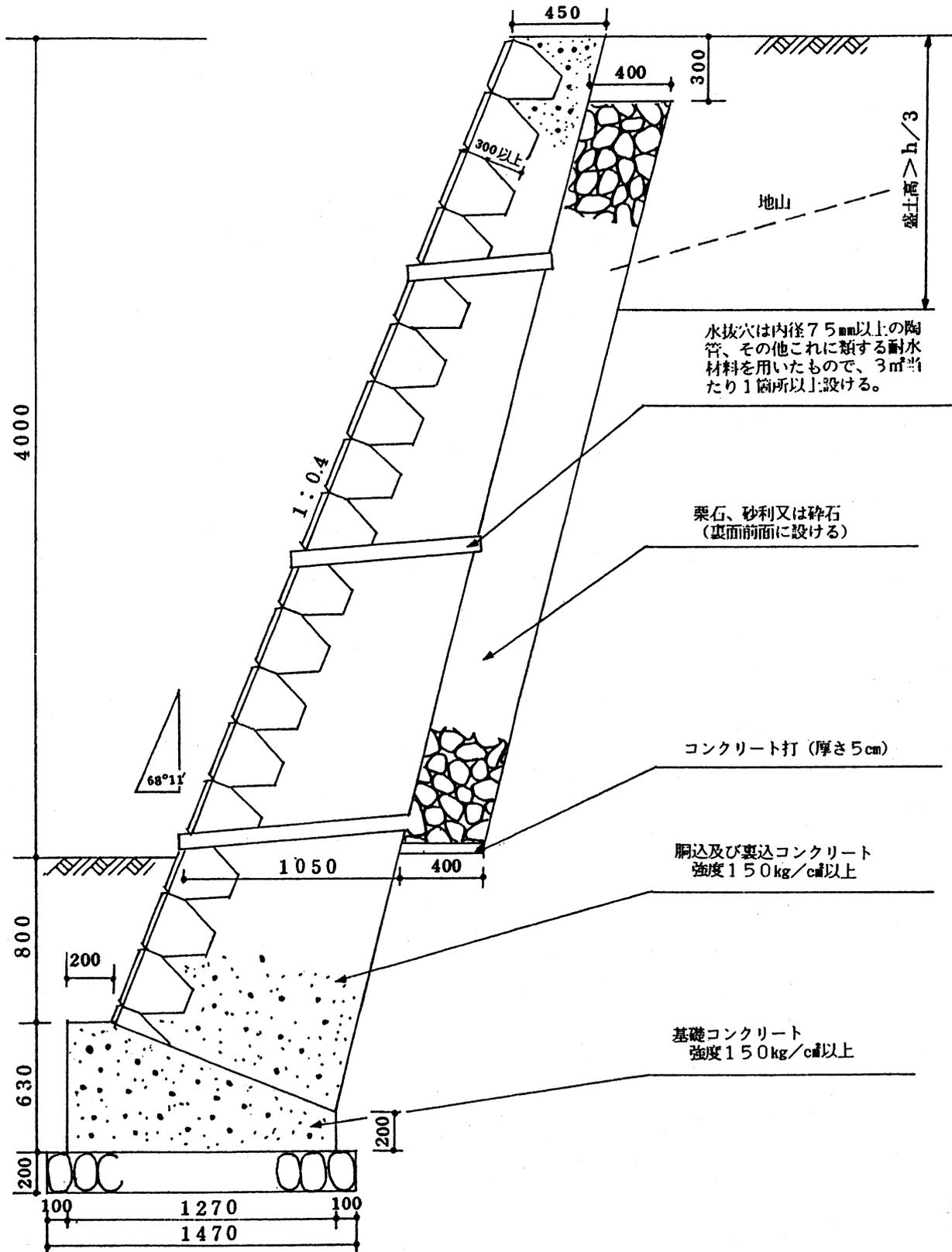
背面土=盛土  $\theta = 65^\circ \sim 70^\circ$  (4分) 最高=4m
