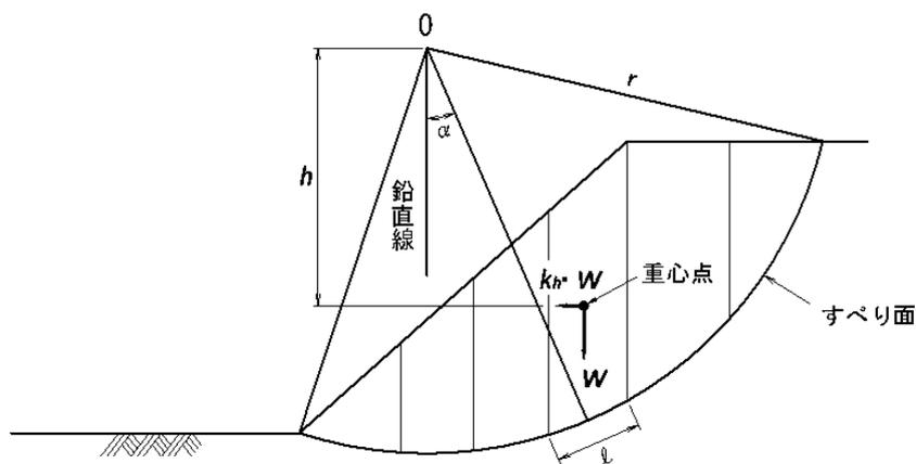
図-2 円形すべり面法における各分割片に働く力 (地震時)
