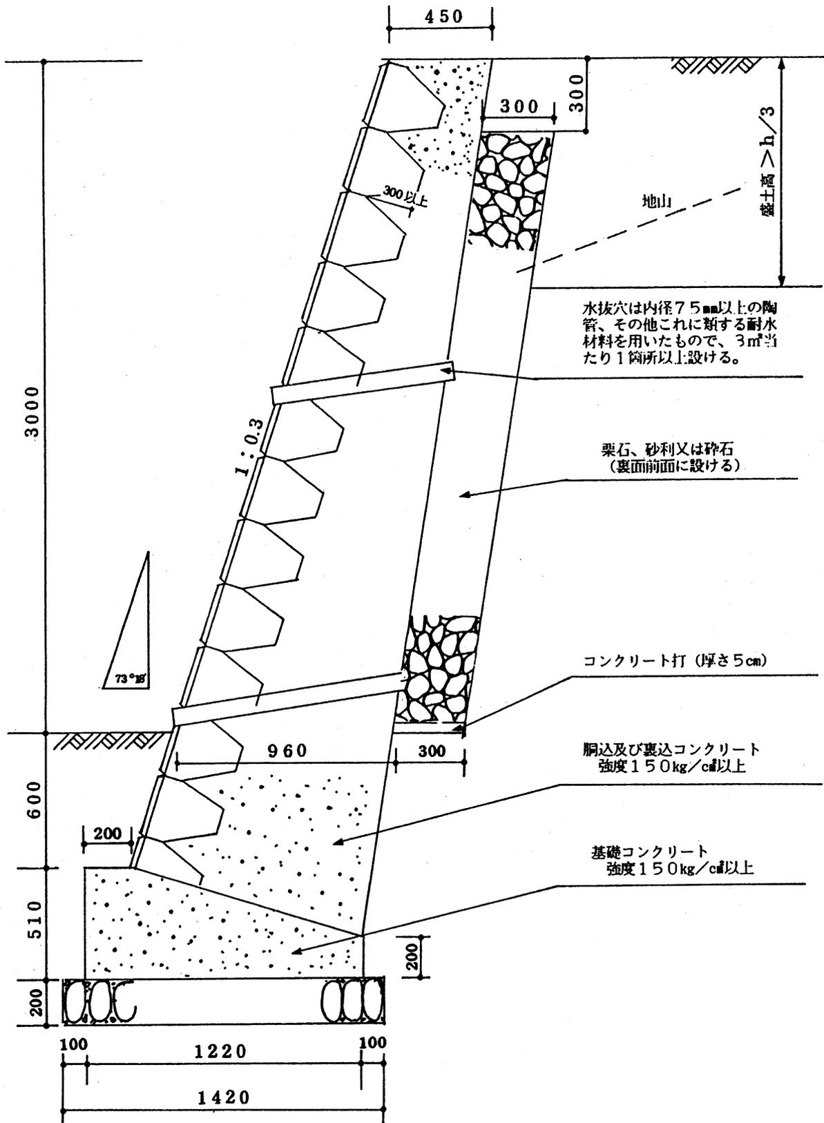
背面土=盛土  $\theta = 70^\circ \sim 75^\circ$  (3分) 最高=3m
