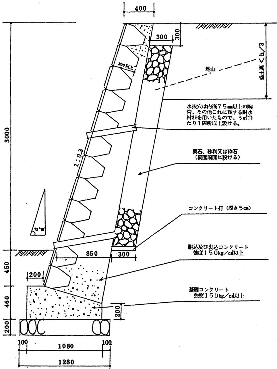
背面土=切土  $\theta = 70^\circ \sim 75^\circ$  (3分) 最高=3m
