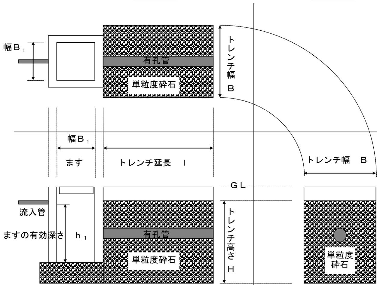
(注) トレンチの有効水深  $h_2$  は、トレンチをある断面で切ったときの空隙の面積をトレンチ幅で除した値で、トレンチが貯留できる水深を表したものである。従って、図面上ではあえて表示していない。
