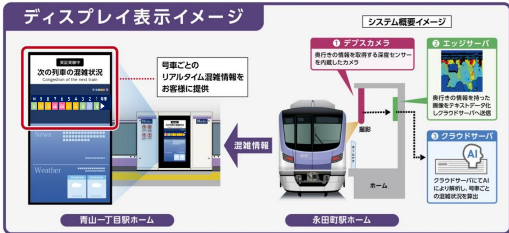
図13 列車・車両別混雑度の計測および混雑情報提供の実証実験
