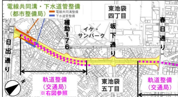
これまで、一部区間で軌道移設及び管路(下水道等)の工事を行いました。今後は、残りの区間の軌道移設工事を行った後、電線共同溝・下水道管等の整備を行っていきます。
