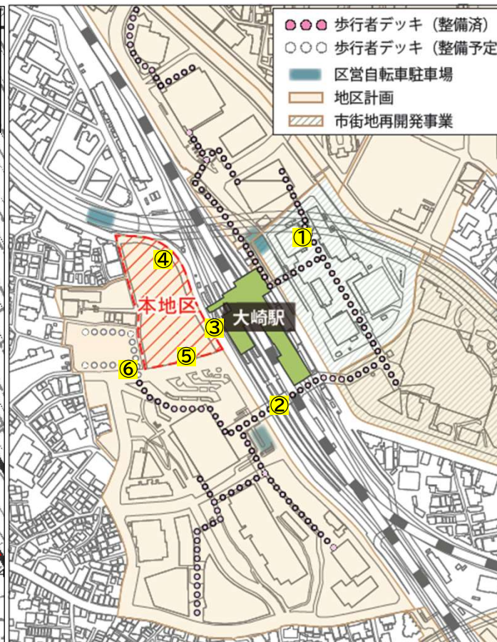
○大崎駅周辺歩行者デッキ状況
