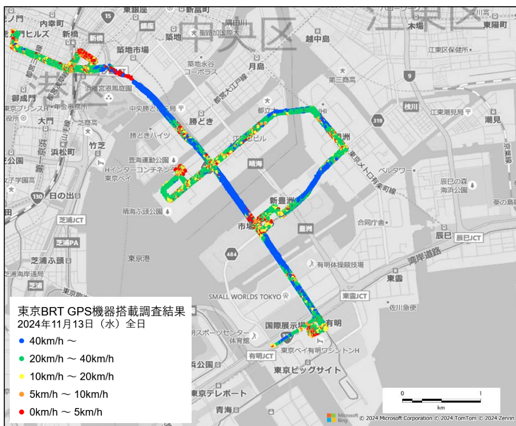
図 2-1-2 東京 BRT GPS 機器搭載調査結果※（令和 6 年 11 月 13 日実施）
