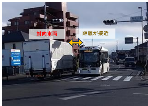
図 参考3-99 対向車との接近による検知例
