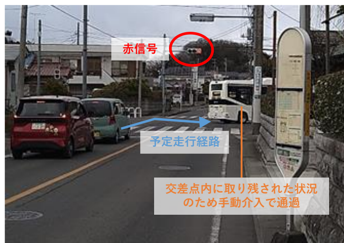
図 参考3-101 右折時の交差点停止による手動介入例
