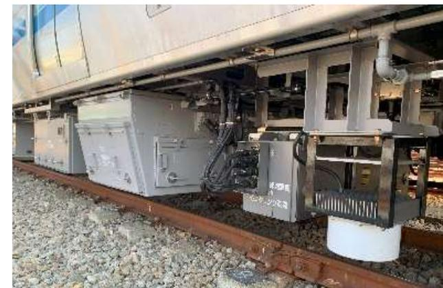
線路設備モニタリング装置
