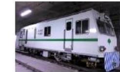
レール計測車の新規導入と保線管理システムの再構築により、地下鉄軌道の維持管理を高度化
