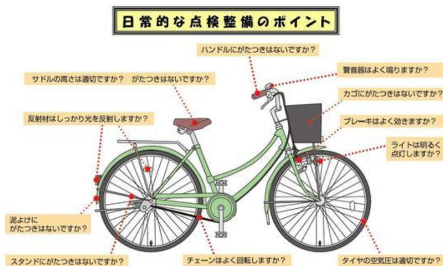
図 4-24 日常的な点検整備のポイント
