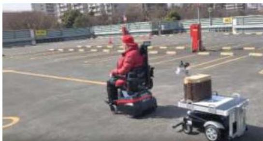
自動車椅子の自動運転の後を自動運搬ロボットが自動追従
