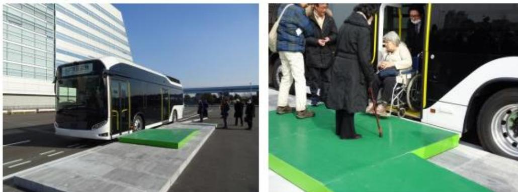
図 3-23 試乗会での正着制御したバスの乗降の様子
