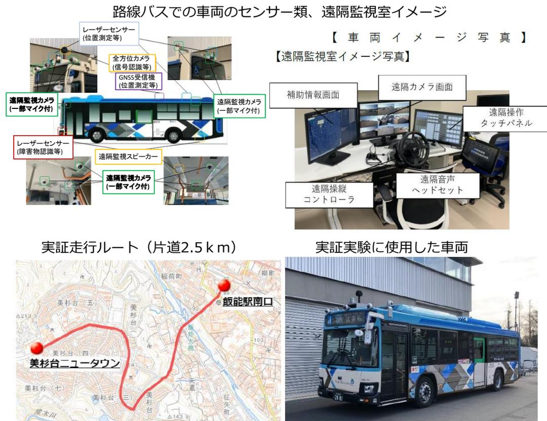
図 3-19 自動運転バスの実証実験事例
