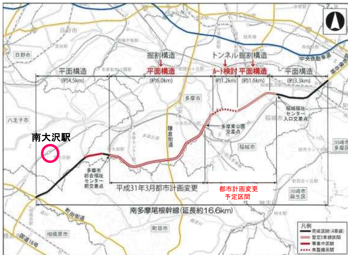
出典:南多摩尾根幹線の整備方針(2019(令和元)年8月 東京都)より一部加工
